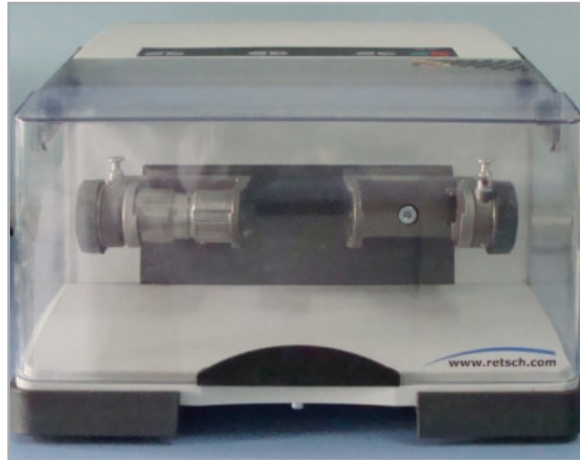
Resim 2: Kemik tozu hazırlama metodunda kullanılan kemik öğütme cihazı
