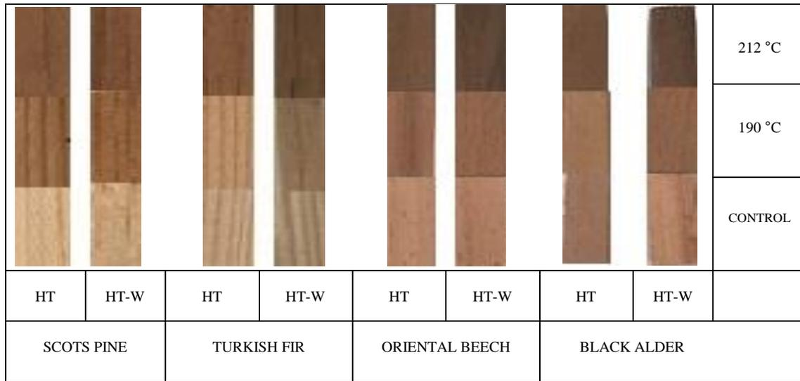
**Figure 3.** Yaşlandırma öncesi ve sonrası örneklerin renk değişimleri (The color changes of the samples according to before and after weathering).
