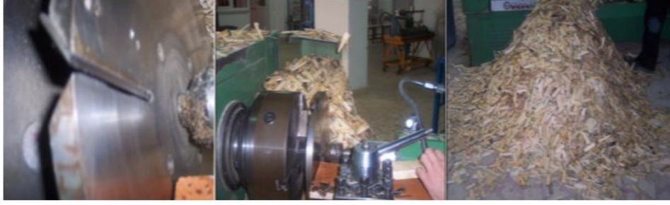
Şekil 2. Strandlerin elde edilme işlemleri (Strand obtaining processes)
