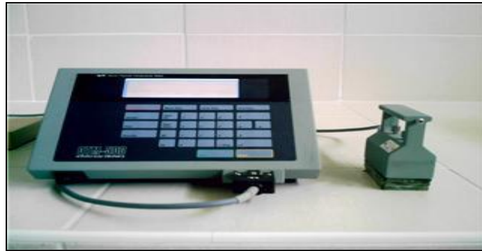
Şekil 3. Isı iletim katsayısı ölçüm cihazı (Thermal conductivity measuring device)
