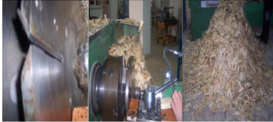
Şekil 2. Strandlerin elde edilme işlemleri (Strand obtaining processes)
