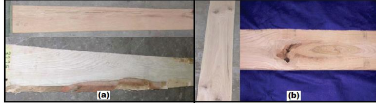
Şekil 1. Kereste kusurlarının boyuna (a) ve enine (b) yönde giderilmesi (Elimination on the longitudinal (a) and transverse (b) directions of timber defects).
