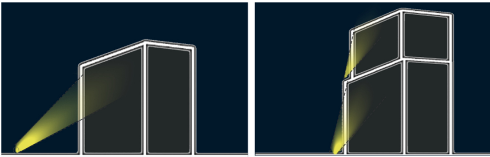
Şekil 3.1 Uzaktan ve yakından aydınlatma çalışma tekniği (Çam Gün, 2015)
