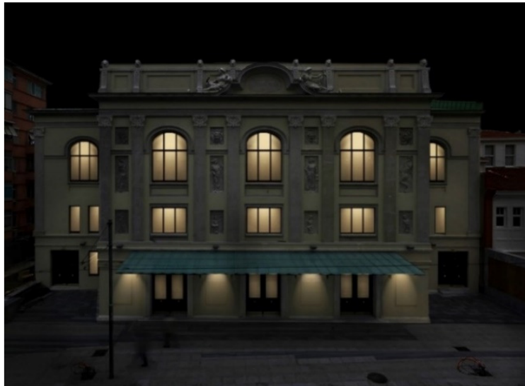
Şekil 5.3 Geçen ışıklılık tekniđi uygulaması
