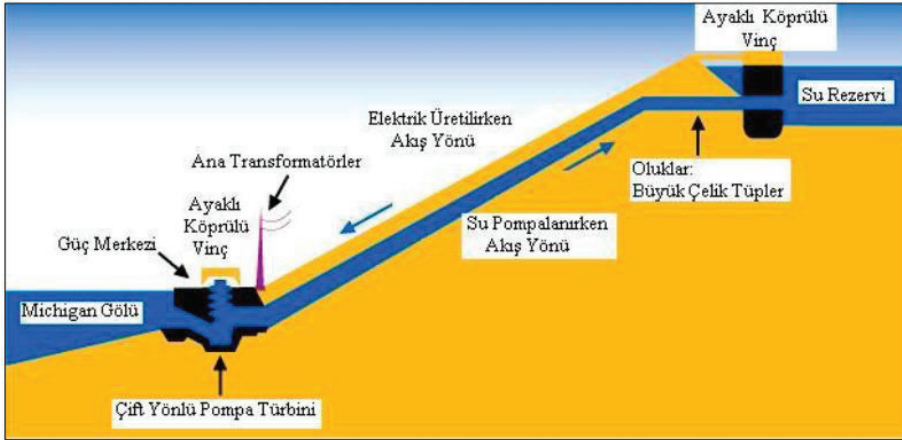
Şekil 7. Basınçlı su depolama şeması (Parrilla ve diğ., 2023)
