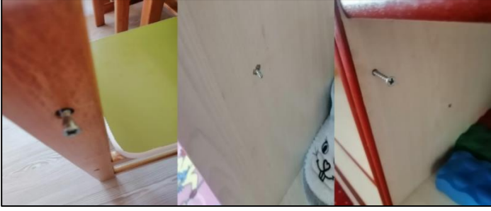
Şekil 8. Okul öncesi eğitim kurumlarına ait ahşap donatılarda bazı çivi-vida bağlantı hasarları
