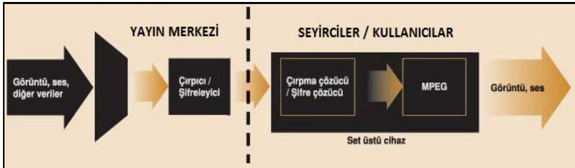
Şekil 3: Koşullu Erişim Ünitesi (CA) Teknik İşleyiş Şeması
