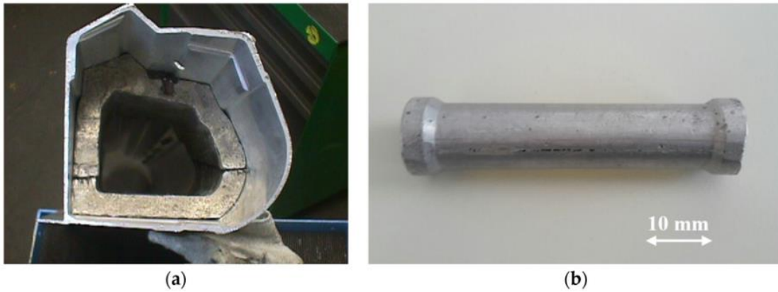
Şekil 32. Alulight tarafından Ferrari 360 ve 430 Spider için geliştirilen Al-köpük sönümlenme parçası (a) ve Audi Q7 için geliştirilen küçük çarpışma sönümlenme elemanı (b) (Al-foam damping element developed by Alulight for Ferrari 360 and 430 Spider (a) and small crash damping element developed for Audi Q7 (b)) [165].
