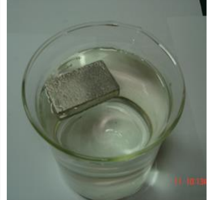
Şekil 2. Düşük yoğunluklu kapalı gözenekli Al köpük (Low density closed pore Al foam)
