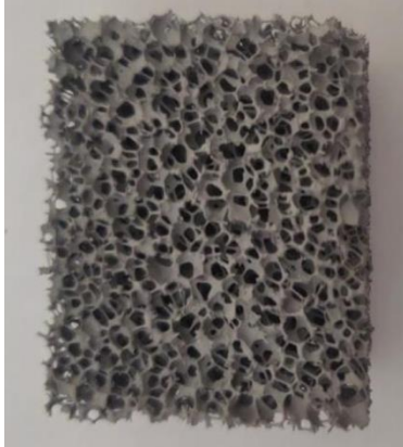
Şekil 1. Açık ve kapalı gözenekli yapıya sahip Al köpük malzemelerin gözenek yapıları (Pore structures of Al foam materials with open and closed pore structure)
