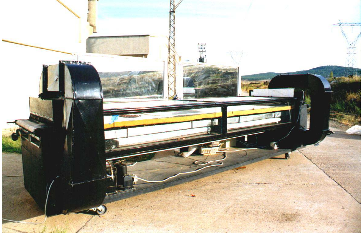
Şekil 1. Güneş enerjili ve ısı depolamalı (PCM) çok amaçlı kurutucunun geri kazanımlı dış hava kanal bağlantılı görünüşü.
