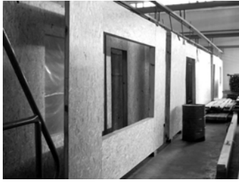
Şekil 13. Fabrikada yüksek hassasiyetle üretilmiş çatı (üstte) ve duvar (altta) panelleri (17)
