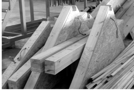
Şekil 14. İçlerine taşıma kayışları yerleştirilmiş çatı panelleri (17)
