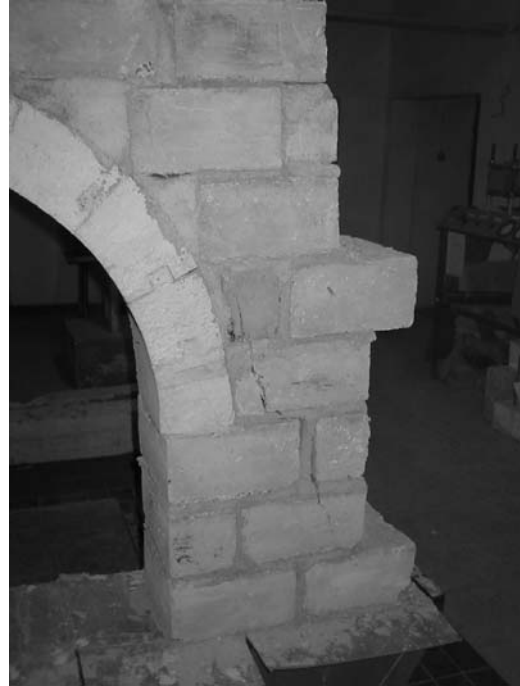
Şekil 7. Geçmeli harçlı kemerde görülen deformasyonlar.
