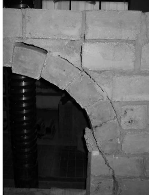
Şekil 6. Düz harçsız kemerde görülen deformasyonlar.
