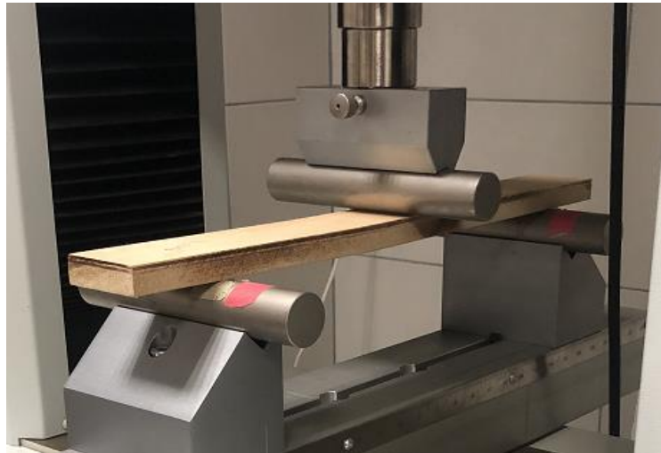
Şekil 2. Üç noktalı eğilme deneyi.
