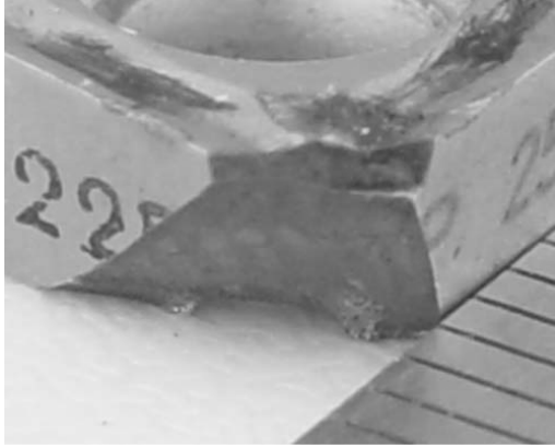
Şekil 15. Takım kırılması (Kesici uç: P15; kanal derinliği: 1.2mm; f=0.25 mm/dev; d=2 mm)
