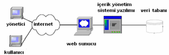
Şekil 1.1. İçerik yönetim sisteminin blok şeması
