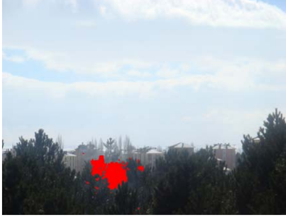
Şekil 11. İki resmin farkı alındıktan sonra dumanın algılanması ve yangın tespiti
