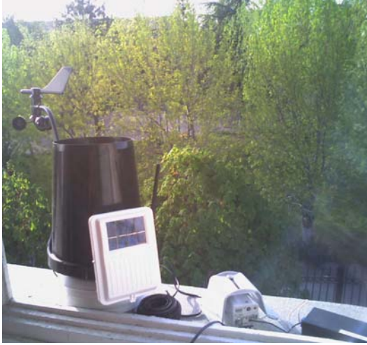
Şekil 2. Sistemde kullanılan meteoroloji istasyonu ve kamera rilek gözlenen alanda yangın olup olmadığı tespit edilir. Gözlenen alana dağıtılan algılayıcı düğümlerinde ise sıcaklık, nem ve duman algılayıcıları bulunur. Algılayıcılardan alınan verilerin değişimine göre bölgede yangın olup olmadığı tespit edilir. Sistemin boyutlarında bulunan bu işlemleri gerçekleştirecek veri birleştirme süreci aşağıda anlatılmıştır.
