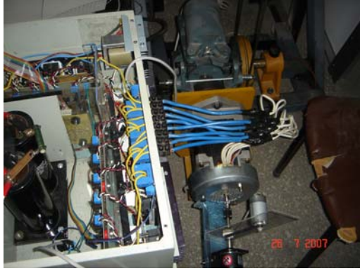
Şekil 18. ARM'nin asansöre tespit edilişi ve ARM sürücüsü
