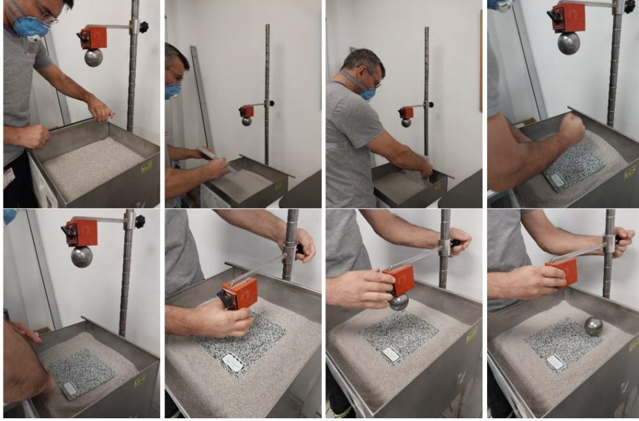
Şekil 4. Darbe dayanım testinin yapımı
