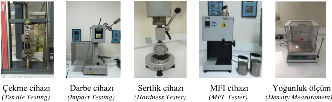
Şekil 3. LDPE/Fe polimer kompozitinin özelliklerinin belirlenmesinde kullanılan cihazlar ( Devices Used for Determining the Properties of LDPE/Fe Polymer Composite )
