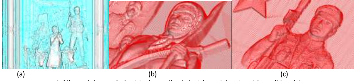
Şekil 15. Alphacam ile kesici takım yolları kaba işleme (a) ve ince işleme (b) ve (c).
