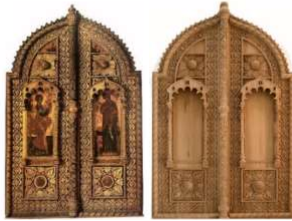
Şekil 3. 17. yüzyıl çift kanat Berna kapısının 3D dijital tarama ile modellenip ahşaba yapılması (Barboutis ve ark. 2023)
