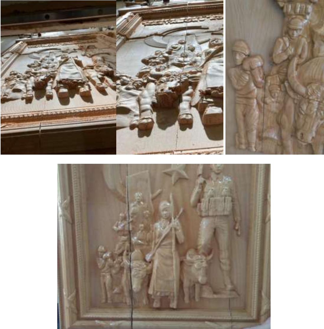
Şekil 23. Kayın ağaç malzemesinde birleştirme yerlerindeki sorunlar
