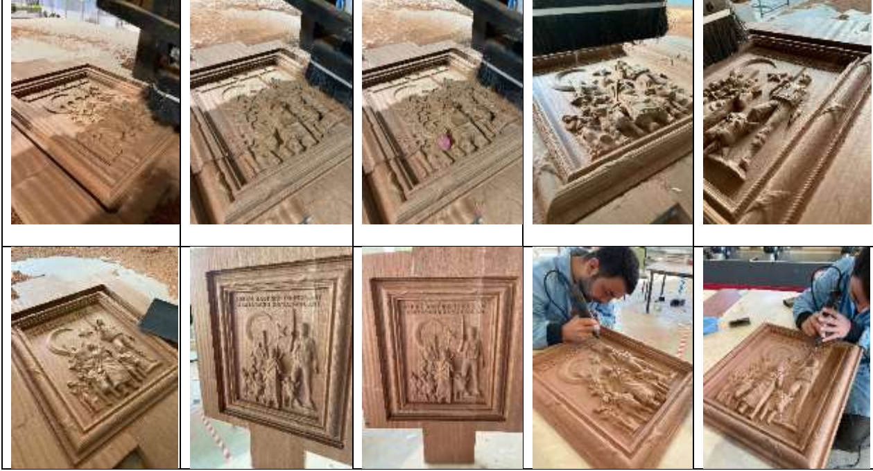
Şekil 18. Sapelli ağaç malzemesi ile CNC uygulaması
