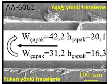
Şekil 18. Mikro kanal frezelemede frezeleme yönünün çapak tipine etkisi (Effect of milling direction on burr type in micro slot milling) [154]
