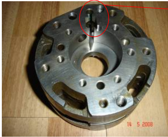
Resim 1. Türbin palet kanalına açılan montaj yuvası
