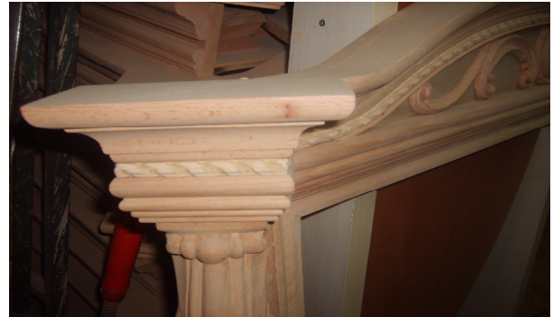
Resim 2. Kavisli mobilyada baskı macunlu oyma uygulaması (1)
