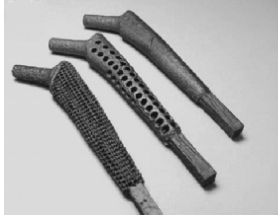
Şekil 8. EBM yöntemi ile üretilen kalça implantı [62]
