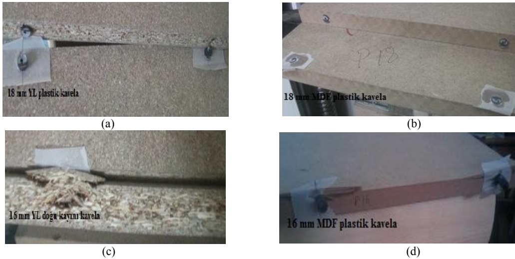
Şekil 6. L-tipi köşe birleştirme elemanlarının diyalagonal basınç deneyi sonrası halleri
