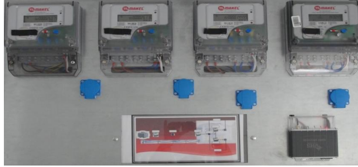
Şekil.6 Dört sayaç ile yapılan uygulama modülü
