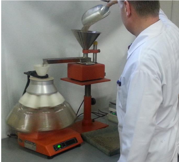
Şekil 5. Dönen numune bölme cihazıyla numune bölünmesi
