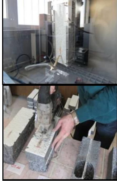
Şekil 5. Sıvalı kaplamanın yangına maruz bırakılması ve iç yüzeyinden bir görünüm (Exposing of plastered board to fire and a view from interior of board)
