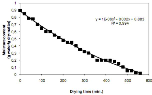
Figure 3. Moisture content of the dry beans during the drying in accordance with time after soaking (Islatılmış kuru fasulyenin kurutma sırasında zamana göre nem içeriği)
