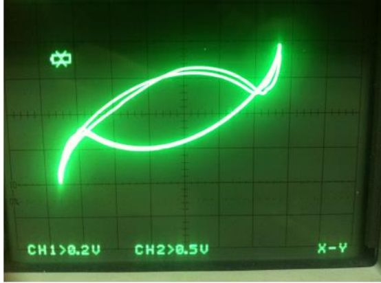
Figure 4. A representative "sweet package" formed attractor from the R2L2D circuit. The input parameters are V_{pp} = 1.49 V and f = 60 kHz. x and y axes are the input voltage V and voltage over R , V_R , respectively. (R2L2D devresinden elde edilen örnek bir "şeker paketi" biçimli çekici. Giriş parametreleri V_{pp} = 1.49 V ve f = 60 kHz. x ve y eksenleri sırasıyla giriş gerilimi V ve R üzerinde gerilim V_R 'dir.)
