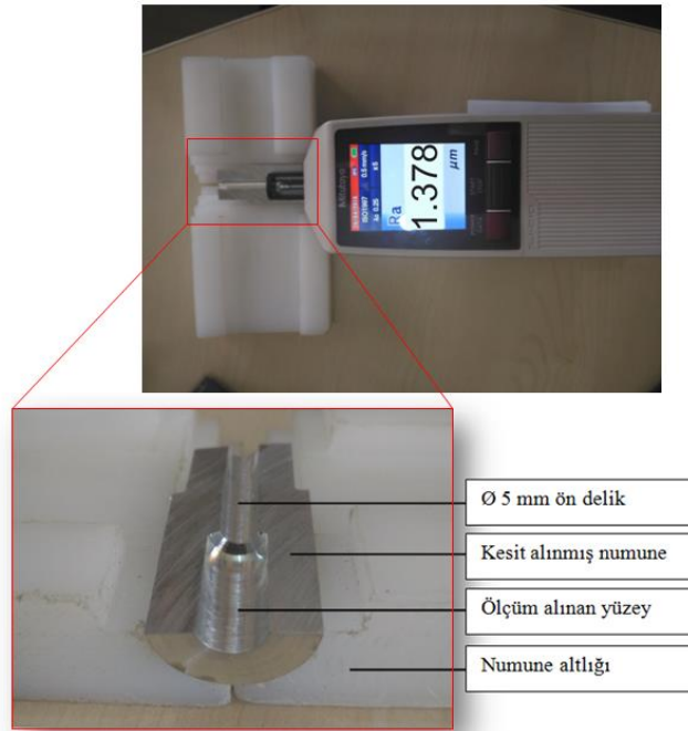
Şekil 2. Deney numunesi ve yüzey pürüzlülüğü ölçümü. (Specimen and surface roughness measurement)
