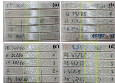
Şekil 6. Eğilme testi sonucu hasara uğrayan numuneler
