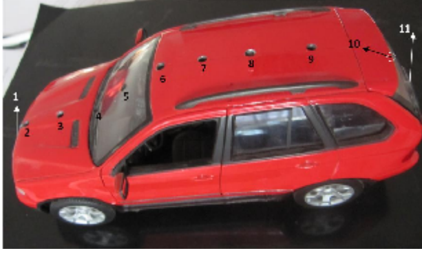
Şekil 3. Basınç ölçümü için model araç üzerine açılan portlar
