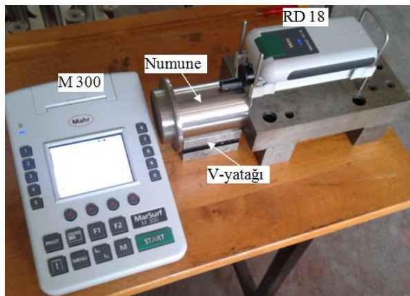
Şekil 1. Numunelerin yüzey pürüzlülüğünün ölçülmesi (Surface roughness measurement of specimens)
