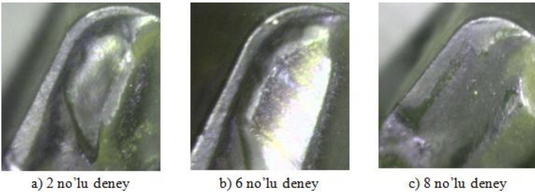
Şekil 8. Düşük pürüzlülük ve pürüzlülük artışına sahip deneylere ait uç görüntüleri (Insert images of experiments with low roughness and roughness increase)
