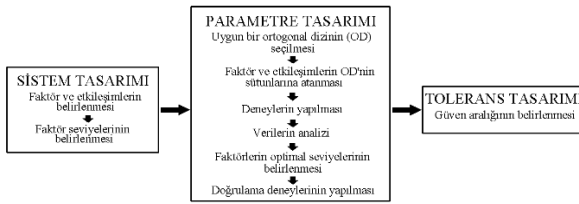
Şekil 5. Taguchi metodunun uygulama adımları [19] (Application steps of Taguchi method)
