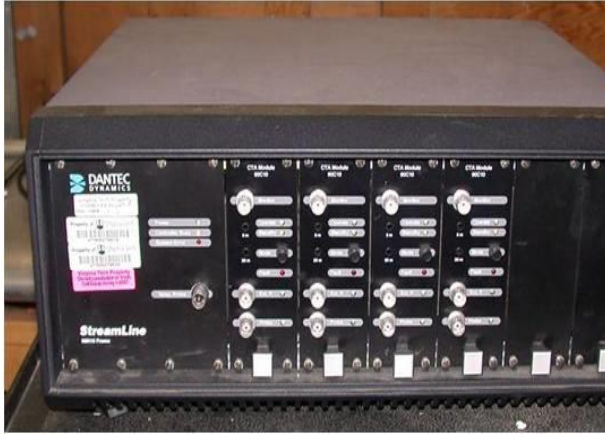
Şekil 4. Sıcak Tel Anemometresi (Hot-wire Anemometer)
