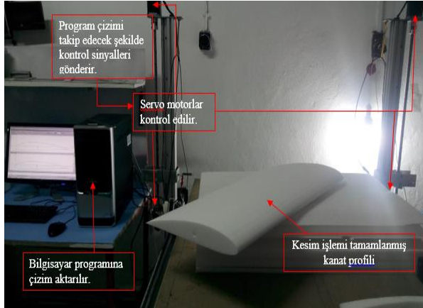
Şekil 9. Kanat profilinin kesim işlemi (Cutting operation of the airfoil)
