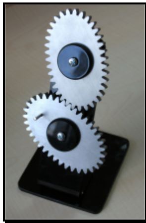
Şekil 7. Diş sayısı 35 ve modülü 2.5 olan eliptik düz dişli çark çiftinin ölçüleri, b) Tel erozyon tezgahında kesimi gerçekleştirilen eliptik düz dişli çark çiftinin prototipi
