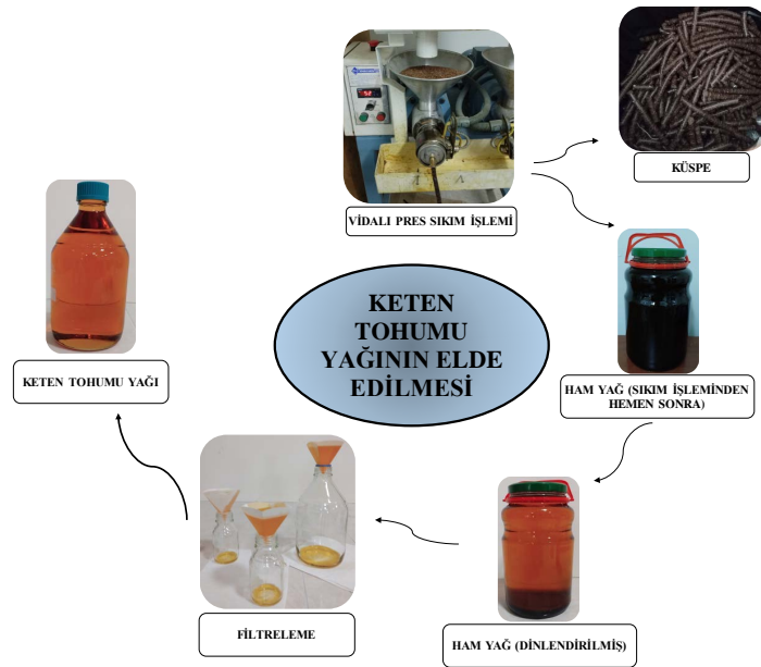
Şekil 1. Keten tohumundan yağ çıkarma işlem aşamaları
