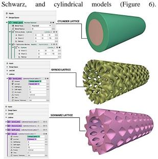
Figure 6. Nerve guide conduits design parameters
