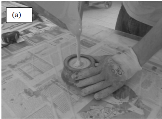
Şekil 5. a) Mini Abrams konisi ve b) yayılma değerlerinin ölçülmesi ( a) Mini-Abrams cone and b) Measurement of spreading values)
