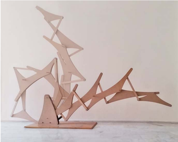
Şekil 8. Dört antiparallelkenar devreden oluşan mekanizma (A mechanism consists of four antiparallel loops)
