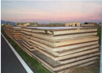
Şekil 9. Çelik muhafaza profilili prekast beton döşemeler [5].
