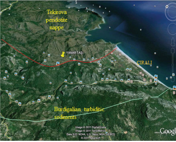
Şekil 7. Antalya naplarına ait Tekirova peridotit napının bölgesel yayılımı ve Çıralı doğal gaz emaresinin (Chimaera-Yanartaş) Google Earth uydu görüntüsü üzerinde ki yeri. Kırmızı çizgi Tekirova peridotit napının güney sınırını göstermektedir.
