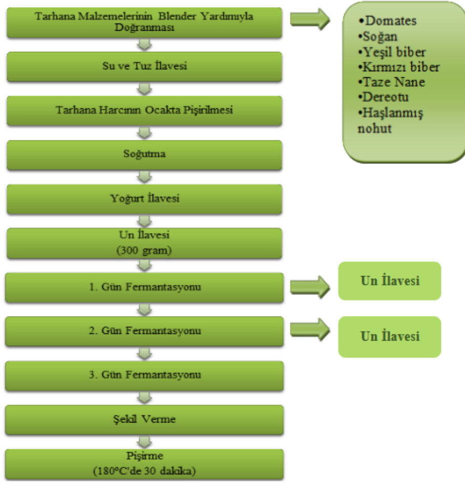
Şekil 2. Tarhana Ekmeklerinin Üretim Akış Şeması
