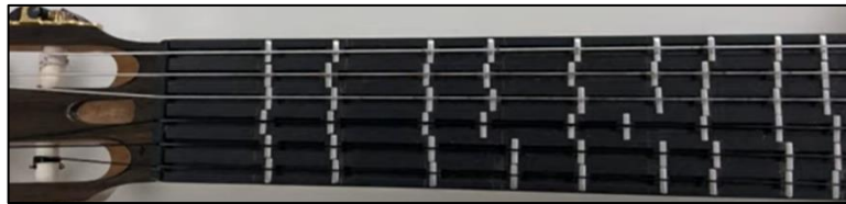
Şekil 3: Altı telli ayarlanabilir mikrotonal gitar (Url-9).
