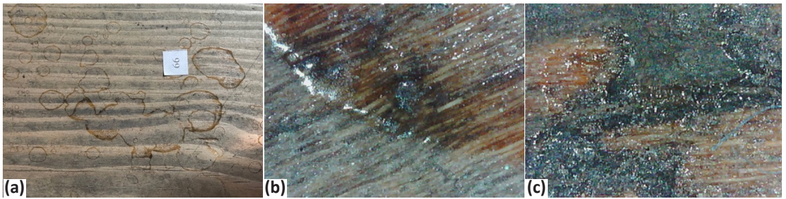
Resim 16. Şeyh Bahşi Mescidi Vaaz Kürsüsü yüzey lekelenme örnekleri. (a) Fotoğraf makinesi çekimi (b) Optik Mikroskopta x50 büyüklükte tabaka detay görüntüsü (c) Optik Mikroskopta x200 büyüklükte tabaka detay görüntüsü.
