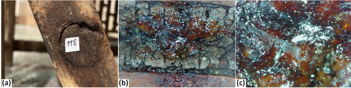
Resim 3. Şeyh Bahşi Mescidi Vaaz Kürsüsü, budaklı ahşap kullanım hasarı örneği. (a) Fotoğraf makinesi çekimi b) Optik Mikroskopta x50 büyüklükte tabaka detay görüntüsü b) Optik Mikroskopta x200 büyüklükte tabaka detay görüntüsü.
