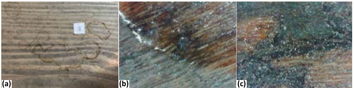
Resim 16. Şeyh Bahşi Mescidi Vaaz Kürsüsü yüzey lekelenme örnekleri. (a) Fotoğraf makinesi çekimi (b) Optik Mikroskopta x50 büyüklükte tabaka detay görüntüsü (c) Optik Mikroskopta x200 büyüklükte tabaka detay görüntüsü.
