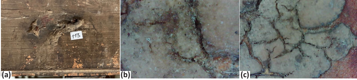
Resim 22. Şeyh Bahşi Mescidi Vaaz Kürsüsü farklı dolgu malzeme ile yapılan destek görüntü detayı. (a) Fotoğraf makinesi çekimi b) Optik Mikroskopta x50 büyüklükte tabaka detay görüntüsü b) Optik Mikroskopta x200 büyüklükte tabaka detay görüntüsü.
