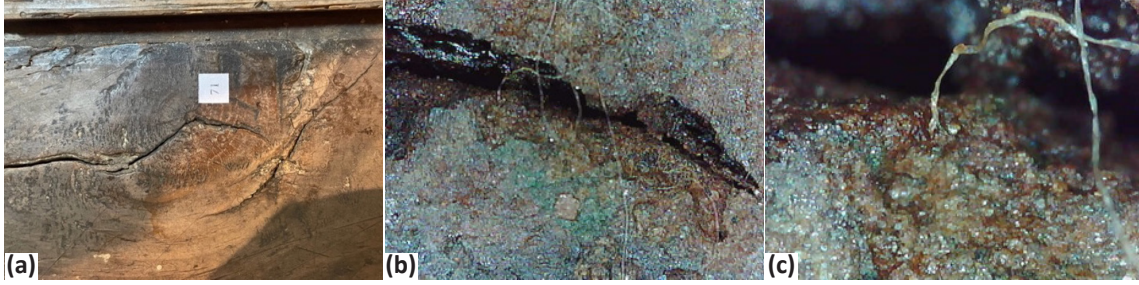
Resim 7. Şeyh Bahşi Mescidi Vaaz Kürsüsü çatlak ve ayrılma örneği. (a) Fotoğraf makinesi çekimi b) Optik Mikroskopta x50 büyüklükte tabaka detay görüntüsü b) Optik Mikroskopta x200 büyüklükte tabaka detay görüntüsü.
