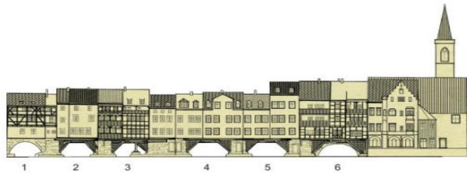
Şek.3 Kramerbrücke, Cephe Kesitinden Numaralanmış Onarım Gören Kemerler (Vockrodt'tan İşlenerek)
