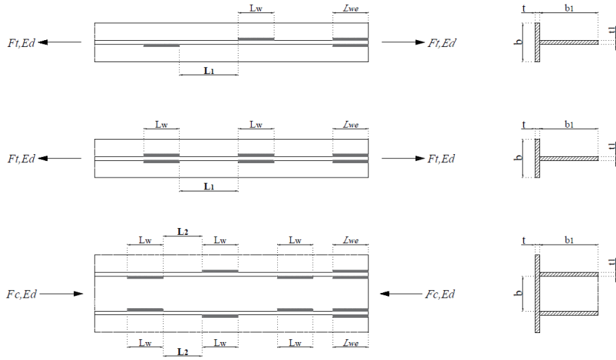
Şekil 14. Aralıklı Metot Köşe Kaynak Boşlukları (L1, L2), Dizimleri Ve Eksanrik Yerleşim Planı (Atak ve Şık, 2015)
