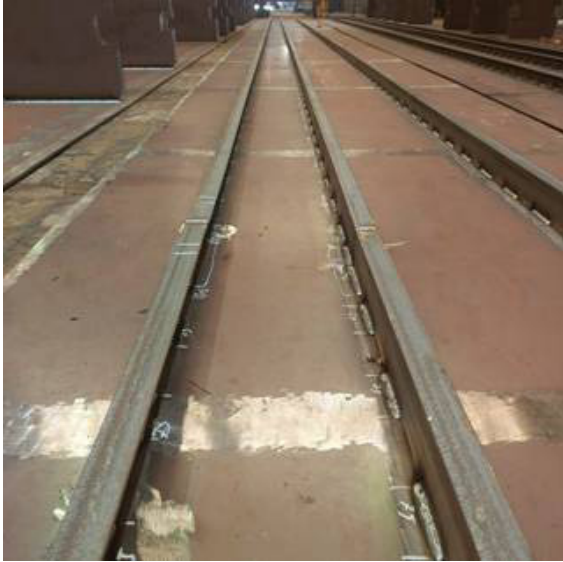
Şekil 16. Vinç Köprü Kirişi Yan Plakalarında Kaynaklı İmalat Prosesinde İdeal Aralıklı Metot Köşe Kaynağı Dizilimleri
