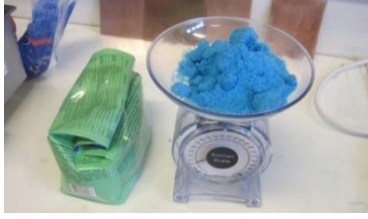
Şekil 41. Tuz Sülfat Aşındırıcının Hazırlanması
