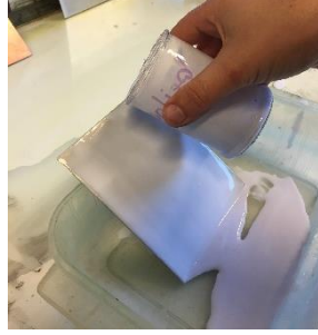
Şekil 1. Polizolanın Plakaya Dökülmesi
