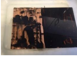
Şekil 17. Şekerli Çini Mürekkebinin Sıcak Suda Çözülerek Desenin Ortaya Çıkması
