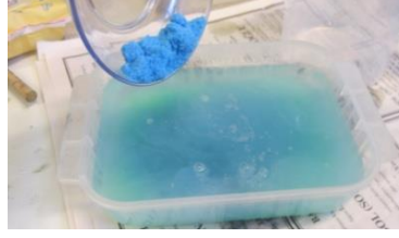
Şekil 42. Tuz Sülfat Aşındırıcının Hazırlanması
