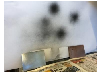
Şekil 11. İki Farklı Plakanın Airbrush İle Mürekkeplenmesi
