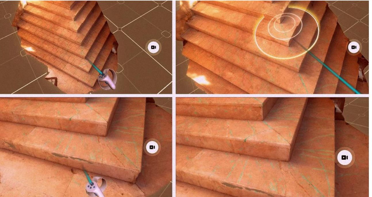
Şekil 8. WEB tabanlı sanal gerçeklik arayüzü ve hasarla artırılmış dijital ikiz ile yapısal denetim
